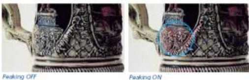
A função "Peaking" pode aplicar um efeito na imagem exibida no monitor LCD ou visor eletrônico que permite operadores ajustar o foco com facilidade. Ela reforça os contornos da imagem a qual a câmera se dirige, e as cores dos contornos se tornam mais visíveis. Os níveis de reforço podem ser selecionados a partir de "HIGH", "MIDDLE", e "LOW", e as cores do contorno de "RED", "WHITE", e "YELLOW".
