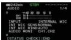
O nível de entrada para os canais CH1 e CH2 pode ser ajustado independentemente utilizando botão de ajuste de nível localizado no corpo da câmera e um visor de medidor de nível no monitor LCD. O medidor de nível de áudio pode ser rapidamente acessado com simplicidade através da função "Status Check".
