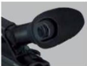
O visor eletrônico colorido em LCD de 0.44 polegadas exibe imagens coloridas em alta resolução com aproximadamente 250.000 elementos de imagem em tela expandida com relação de aspecto 16:9. Operadores podem também selecionar a exibição de imagens em preto e branco. O tamanho do visor foi aumentado para permitir que imagens possam ser vista mesmo por usuários com óculos. O acoplador do olho em tamanho maior permite facilidade de foco e utilização mais confortável.
