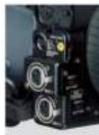
O HVR-Z1 é provido de microfone estéreo embutido de alta qualidade bem como duas entradas de áudio com conector XLR para conectar microfones profissionais ou fonte de áudio externo. Fonte Phantom de 40 V pode alimentar um microfone condensado externo. Na entrada INPUT1, o áudio pode ser gravado somente no CH1 ou em ambos CH1 e CH2 facilmente selecionado através de uma chave seletora.
