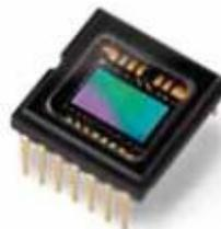
O HVR-Z1 incorpora três CCD 1080i HD de 1/3 de polegada com relação de aspecto 16:9 e um total de 1,12M elementos de imagens (1,012 x 1,111), e com 1,07M (972 x 1,100) elementos de imagens efetivos.
